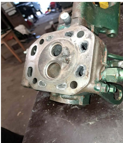
Importante réparation pour le moteur : surfacage de la culasse, changement des soupapes..
